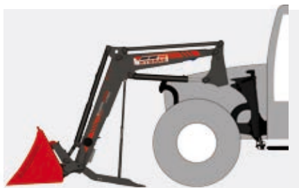
Mechanische Abstellstützen Komfortabel im Stehen bedienbar.
